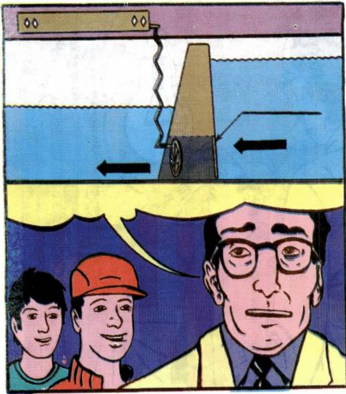
٩ - وتم تطبيق هذه النظرية في نهر النيل ، حيث استغل انحدار الماء الشديد ، من مستوى علوي إلى مستوى سفلي ، في إدارة توربينات مائية تتصل بعولفات كهربائية ، ركبت عند مداخل الأنفاق ، تنتج تيارات كهربائية قوية ، تستغل في إدارة المصانع .
